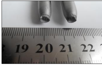
Gambar 6. Sampel Hasil Uji Tarik.
